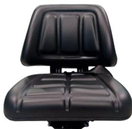
Sedile 300090 in sky nero con molleggio meccanico esterno a schienale. Dotato di un telaio portante in lamiera ed un sistema molleggio che si estende nella parte posteriore del sedile. Seduta e schienale con telaio in lamiera accoppiati solidamente al molleggio. Possibilità di regolazione in altezza dello schienale. Sedile dotato di guide di scorrimento. Utilizzabile per macchine agricole.
