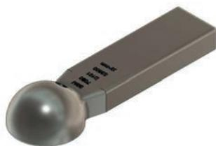
Occhione fisso piatto 88x42mm, con calotta sferica Ø interno 80 mm, lunghezza totale 400mm. Conforme a Mother Regulation 2015/208 e ISO 24347:2005. Max carico verticale (S) 3600kg.
