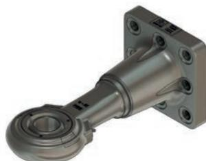
Occhione flangiato con rotula Cat.4, Ø interno 51 mm, lunghezza totale 444 mm. Conforme a Mother Regulation 2015/208 e ISO 21244:2008. Max carico verticale (S) 3000 kg. (S) 3000 kg.
