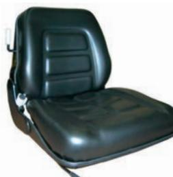
Sedile per carrelli elevatori, cingolati, mini escavatori e pale con molleggio meccanico integrato e microswitch. Rivestimento in sky nero, telaio portante in lamiera, cuscini ergonomici e confortevoli. Regolazione inclinazione schienale 0° - 15°. Guide scorrevoli con corsa 150 mm.
