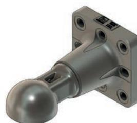
Occhione flangiato con calotta sferica Ø interno 80mm, lunghezza totale 333 mm. Conforme a Mother Regulation 2015/208 e ISO 24347:2005. Max carico verticale (S) 4000 kg.
