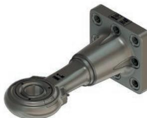
Occhione flangiato con rotula Cat.4, Ø interno 51mm, lunghezza totale 429 mm. Conforme a Mother Regulation 2015/208 e ISO 21244:2008. Max carico verticale (S) 3000 kg.
