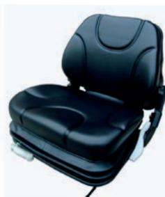
Sedile in sky nero con molleggio meccanico integrato. Dotato di un telaio portante in lamiera. Possibilità di regolazione schienale da -7,5° a +7,5°. Sedile dotato di guide di scorrimento, braccioli regolabili, cinture con arrotolatore, micro presenza uomo. Utilizzabile per macchine movimento terra e macchine agricole, carrelli elevatori e pulizia.
